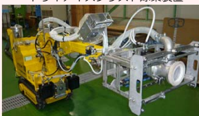
高圧水除染装置
