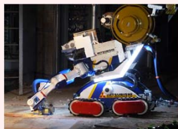
吸引・プラスト除染装置
