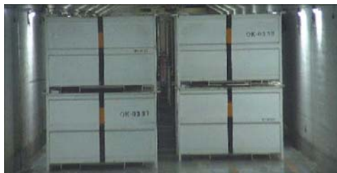
角型容器 (高線量瓦礫類)
