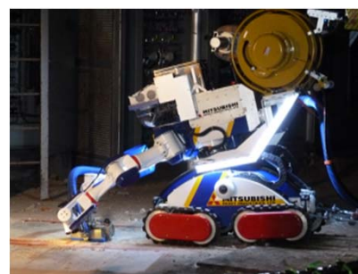
図1 除染時の作業ロボット
