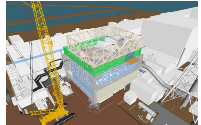
⑥建屋カバー解体完了 ⇒その後、ガレキ撤去作業に移行
