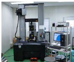
写真5-1 引張試験装置 (JIS L 1096 ストリップ法準拠)
