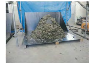
図22-4 D/W外側狭隘部止水材要素試験
