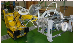
高圧水除染装置
