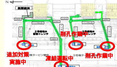
<トレンチ凍結止水 全体状況>
