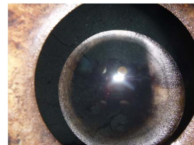
吸着塔8 A 吸着材3（黒色）の上に若 干の白い堆積物を確認
