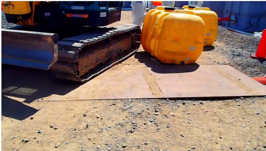
上：再現テスト状況 右上：H5エリアで漏洩したタンクの損傷 右下；再現テストにおけるタンクの損傷
