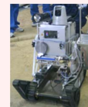
汚染状況調査用ロボット（ガンマカメラ搭載）
