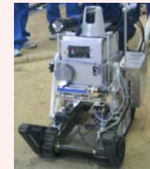
汚染状況調査用ロボット （ガンマカメラ搭載）
