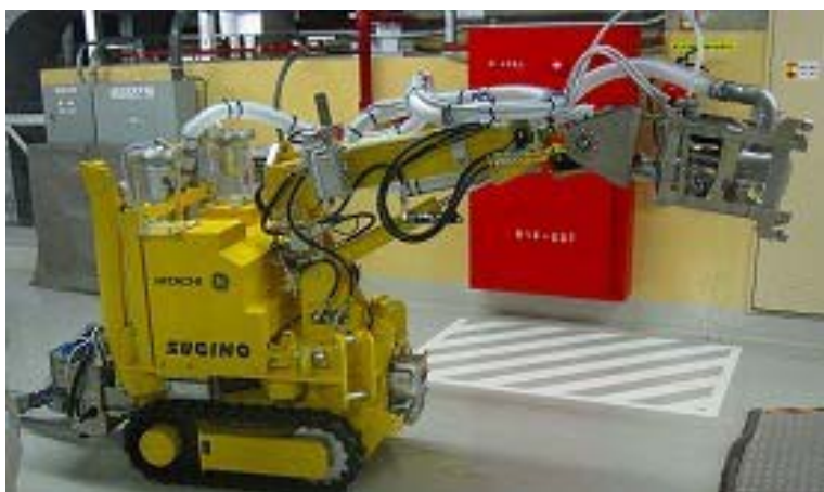
高圧水除染装置
