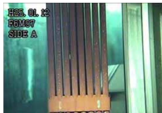
被覆管酸化膜剥離の1例
