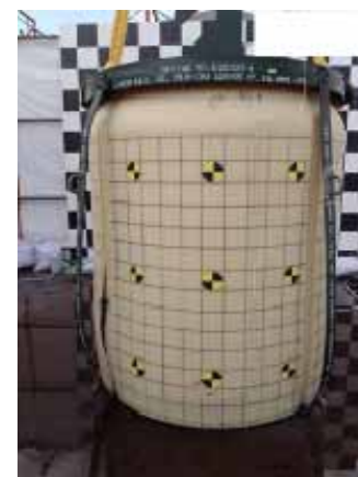
落下後 (落下試験②: 3m落下)
