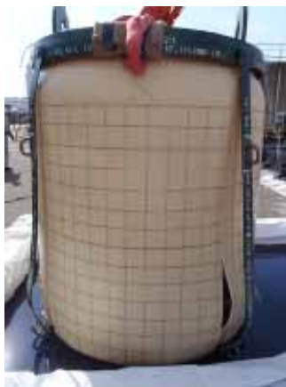
落下後 (試験試験①: 6m落下)
