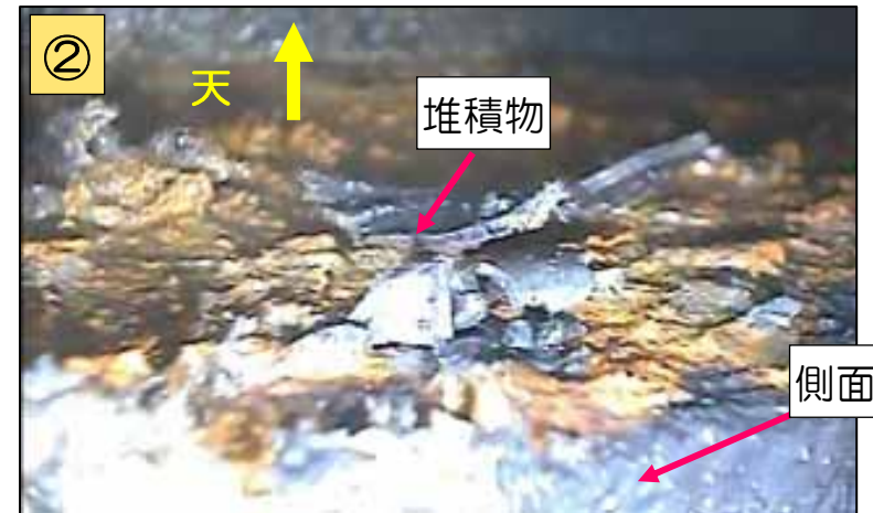
機器ハッチモノレール下側上の堆積物
