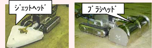
効果を確認した遠隔操作除染装置(ラクーン)
