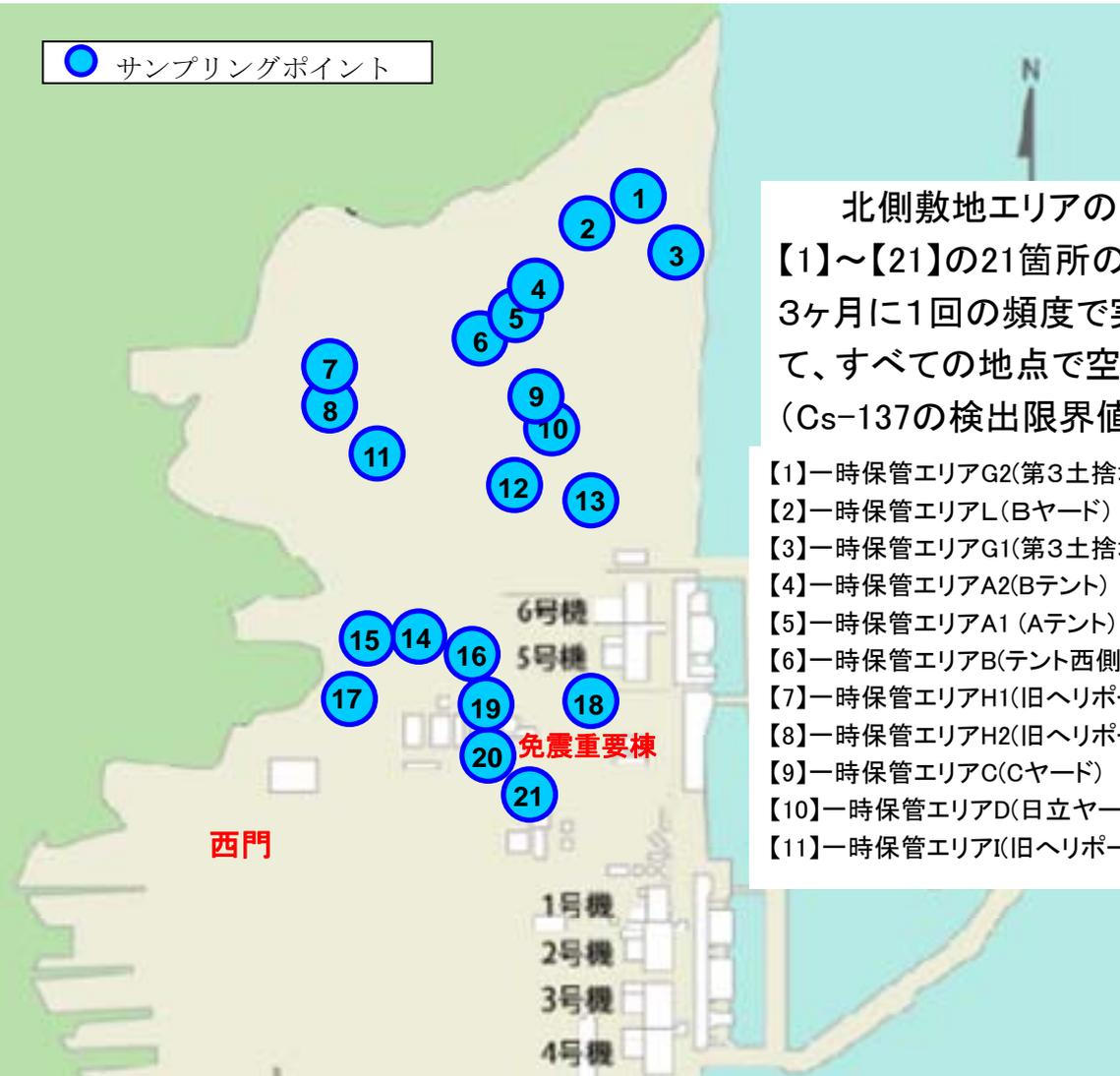
北側敷地エリアの空気中放射性物質の監視は上図のように【1】～【21】の21箇所の各瓦礫等の一時保管エリアの入口（屋外）にて、3ヶ月に1回の頻度で実施している。H24.9～H25.9現在の期間において、すべての地点で空気中放射性物質は検出されていない。（Cs-137の検出限界値は $10^{-6}$ 【Bq/cm<sup>3</sup>】オーダーで測定）
