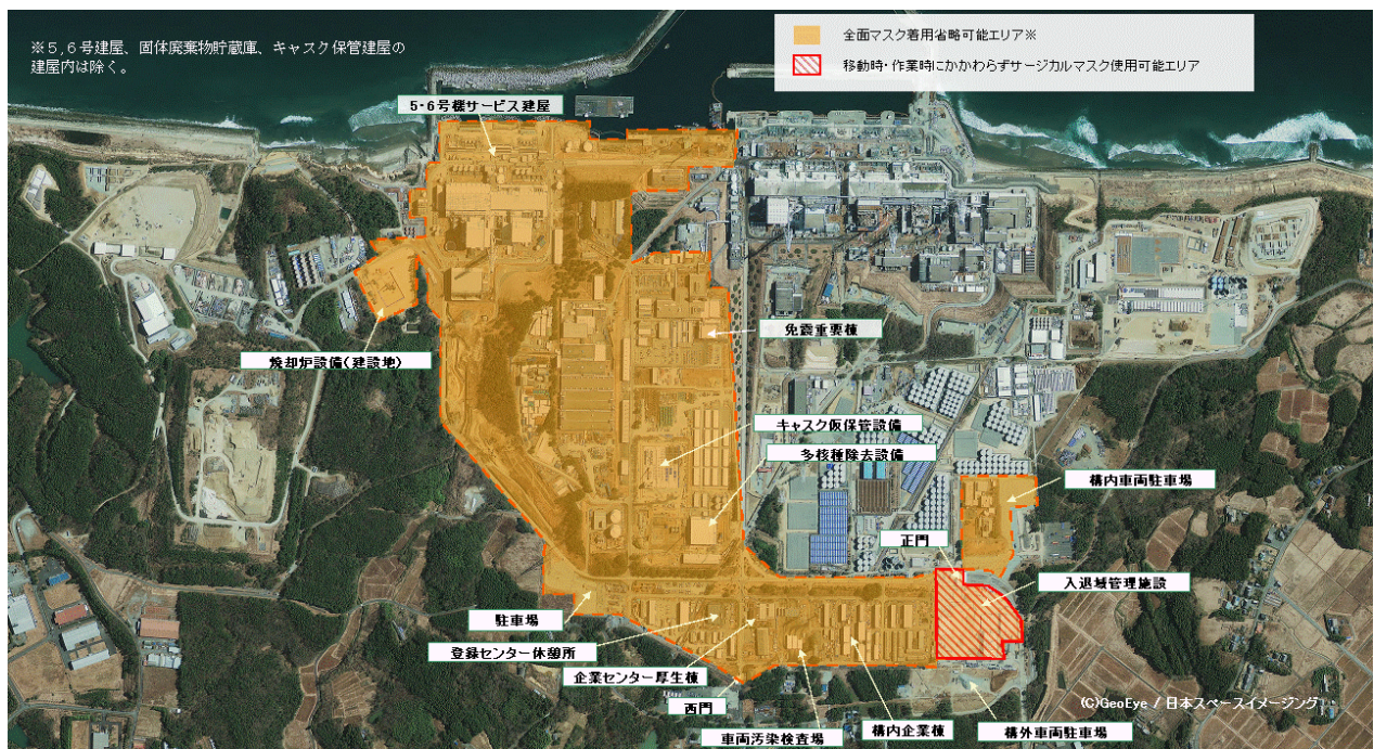
図 21 福島第一原子力発電所構内における全面マスクエリア着用省略可能エリア
