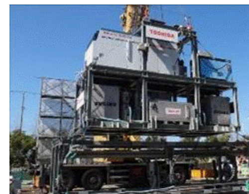
定置式除染装置
