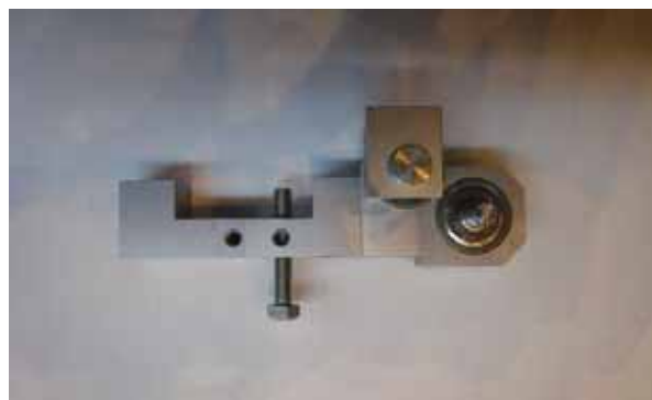
リミットスイッチ検出レバー (腐食前)
