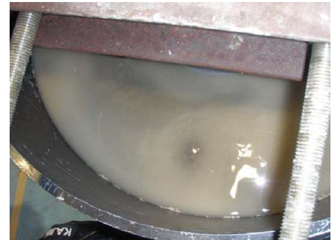
〔打設開始160 分後〕 水みちがダウンカマ界面以外にも発生
