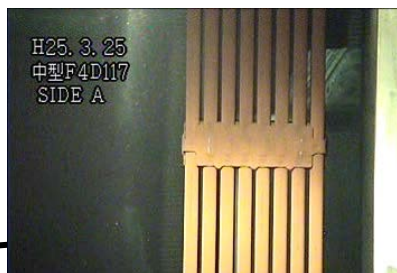
スペーサ、被覆管 変形・損傷無し
