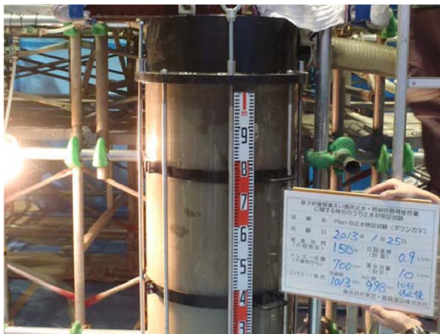
〔打設開始150 分+10 分休止〕 水面から水みちが目視できる
