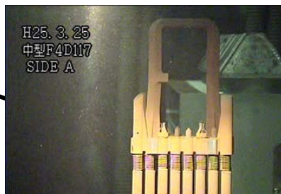
上部タイプレート、被覆管 変形・損傷無し
