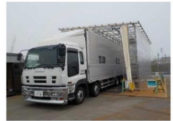
写真⑤: タンク積載トラックへのバラスト水受入状況
