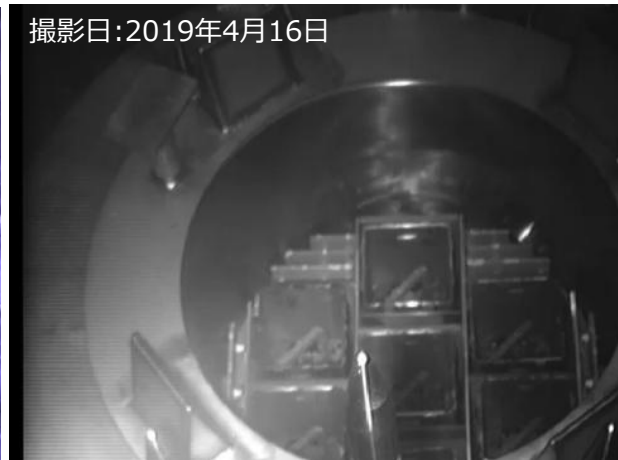
輸送容器へ燃料装填完了(7体)
