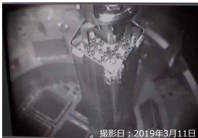
燃料移動訓練の状況（模擬燃料の輸送容器への収納）
