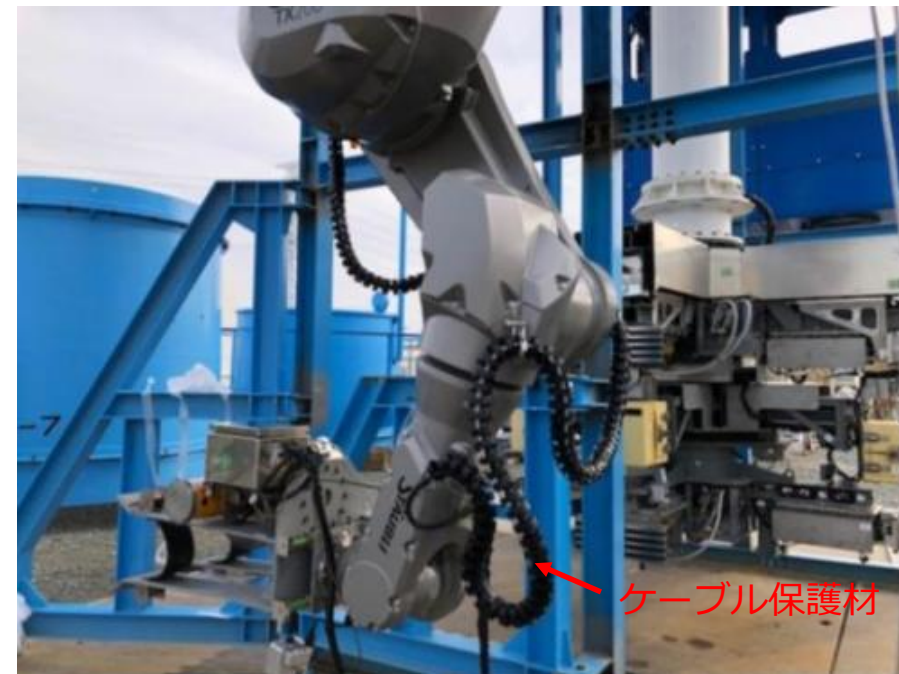
6軸アームロボットケーブル保護材 設置後
