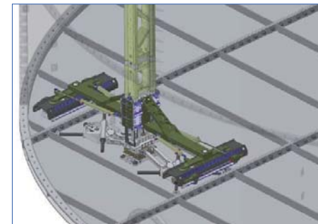
遠隔操作により水が入った状態で タンク底部フランジに補修可能
