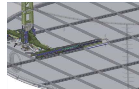
伸長機構によりマストシステム 設置箇所から2フランジ先まで補修可能
