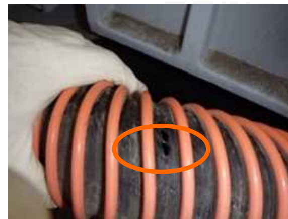
※確認のため、ホースを曲げて当該箇所を拡大させた状態
