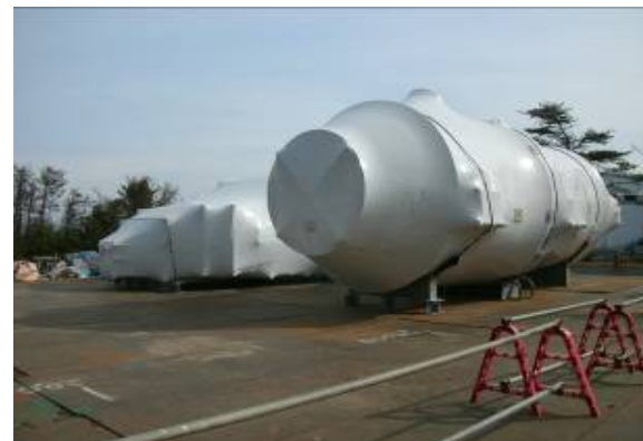
二次燃焼器及び排ガス冷却器 設置前の二次燃焼器と排ガス冷却器。 今後、焼却設備室内に設置。
