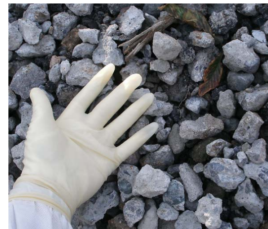
破砕後のコンクリート （拡大）
