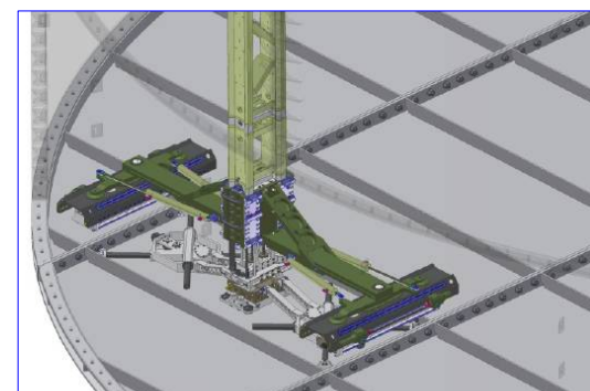
遠隔操作により水が入った状態で タンク底部フランジに補修可能
