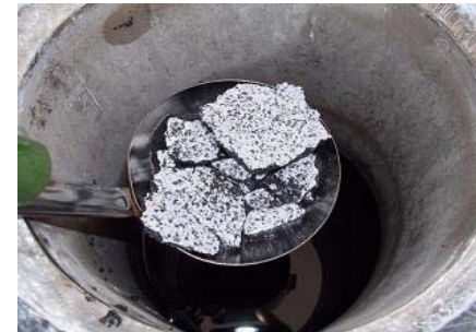
吸着塔1塔目上部堆積物
