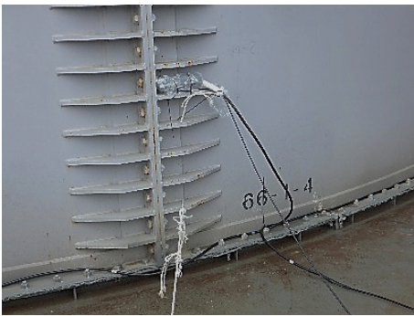
PSF端部(光センサー)を固定
