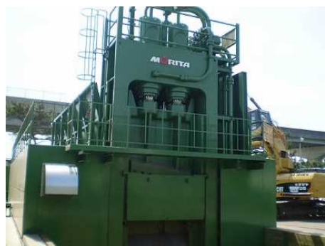
減容処理設備 金属切断機（例）
