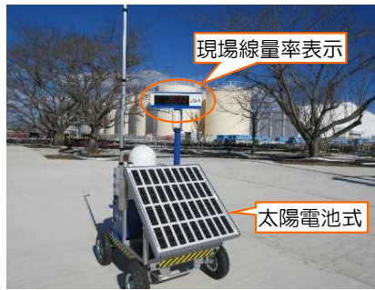
現場線量率モニタの設置状況
