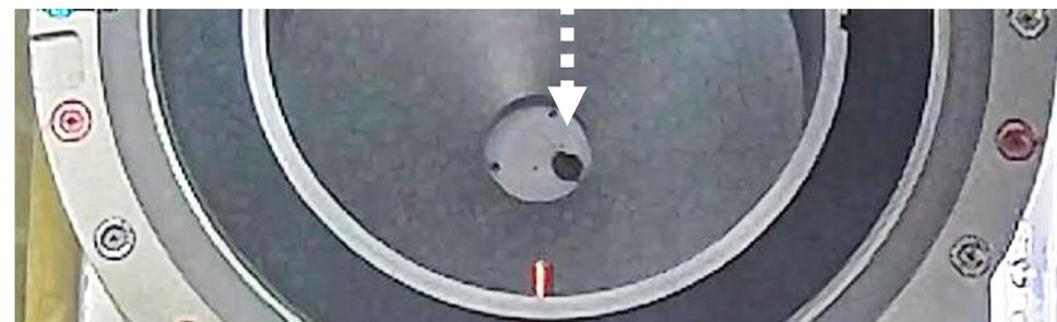
採取した燃料デブリを運搬用ボックスへ収納した状況
