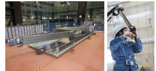
2号機燃料デブリ試験的取り出し装置 操作訓練
