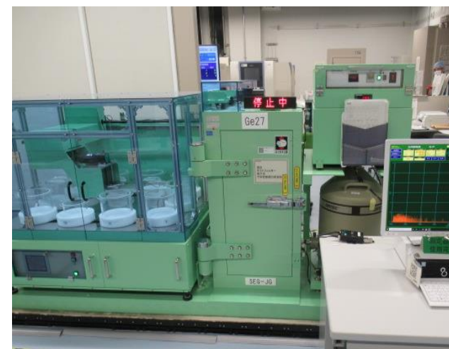
参考：既設ゲルマニウム半導体検出器 (写真は化学分析棟計測室内の装置)
