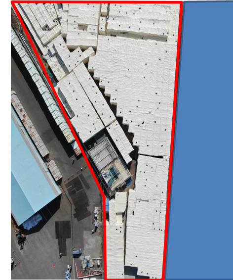
耐候性シートへのリブレース完了 一時保管エリアW1
