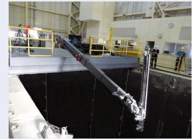
アーム先端部 (ロボットアーム: 最大伸長時約22m、 幅約25×縦約40cm、質量約4.6t、 主な材質ステンレス鋼、アルミニウム合金)
