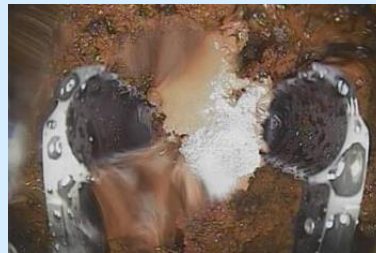
ペDESTAL内堆積物の把持状況
