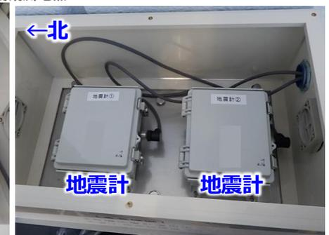
2号機原子炉建屋に設置した地震計 (左：1階レベル、右：5階レベル)
