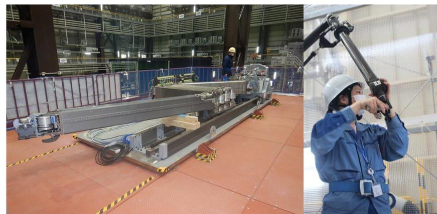
2号機燃料デブリ試験的取り出し装置
