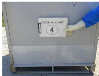
側面下部に著しい腐食があるコンテナ補修
