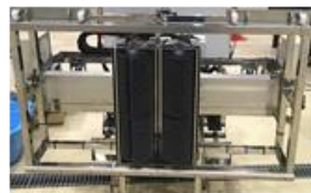
壁面除染装置
