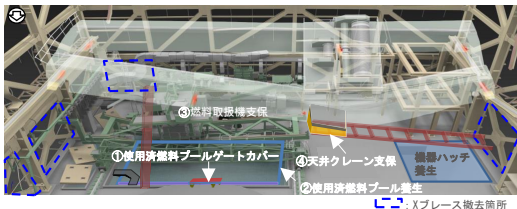
がれき落下防止・緩和対策の概要
