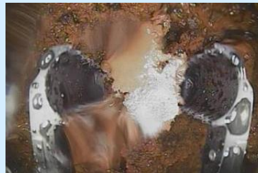
ペDESTAL内堆積物の把持状況
