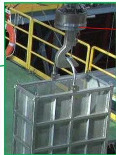
補助ホイスト先端にフック形状のツールを接続し、バスケットを吊り下げて、マニピュレータでつかんだがれきを回収
