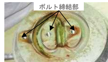
分離したがれき撤去ツール（熊手）の上部
