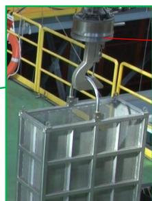
補助ホイス先端にフック形状のツールを接続し、バスケットを吊り下げて、マニピュレータでつかんだがれきを回収
