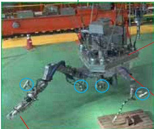
テンシルトラスには、2本のマニピュレータが設置され、がれきのつかみ・切断作業が可能
