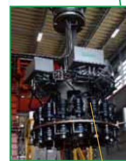
補巻先端に接続した構内用輸送容器蓋締付装置で蓋を締める
