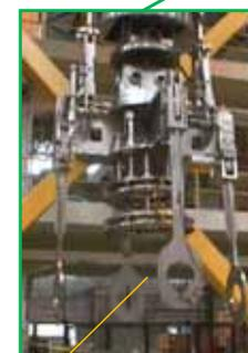
主巻フックに取り付けた吊具で構内用輸送容器を吊り上げる
