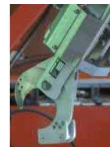
燃料取扱機ツール類 (カッター)
