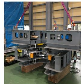
鉄塔解体装置（支柱材用）
