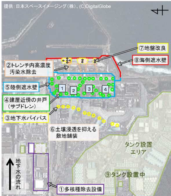
汚染水対策の概要図（敷地平面図）
