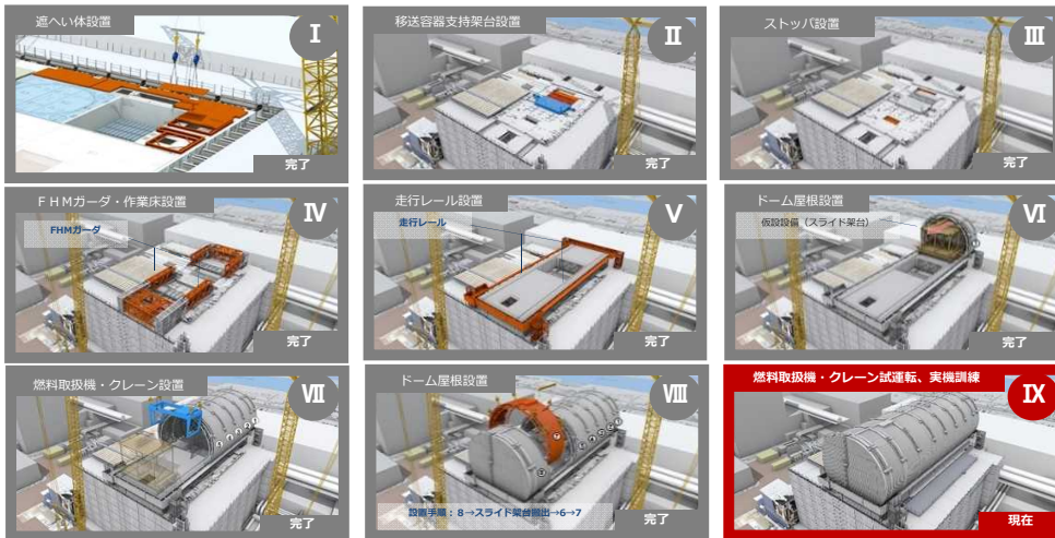
<1-12. 燃料取り出し用カバー等設置の作業ステップ>
