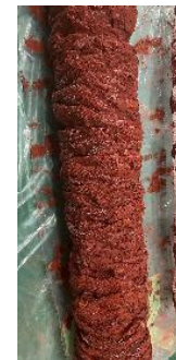
取り出したフィルタの状況 （赤色は酸化鉄）
