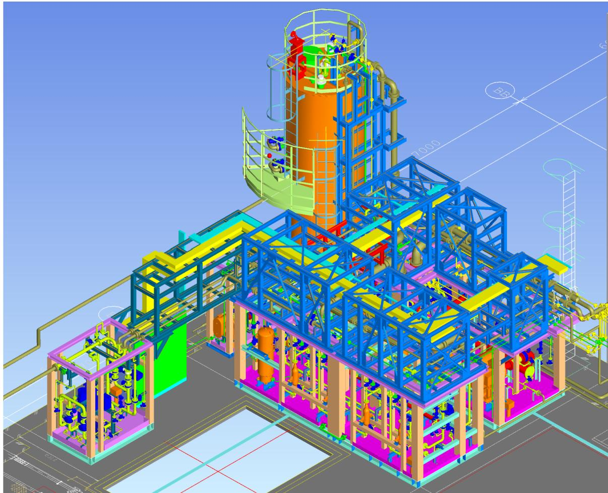
セシウム吸着装置後段フィルタ装置の設置イメージ（サイトバンカ建屋2階）
