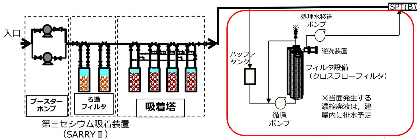
新設（セシウム吸着装置後段フィルタ設備（ $\alpha$ 核種除去設備））
