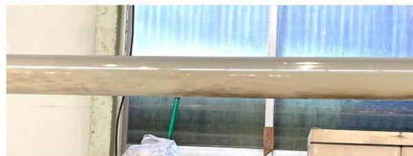
移送試験（平均移送濃度 3 wt%程度）
