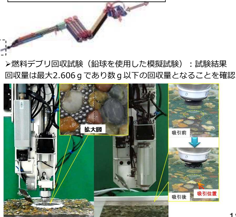
ロボットアームによるデブリ採取
