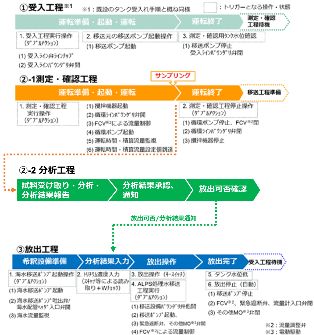
図 1.1.5-3 受入，測定・確認，放出工程の手順
