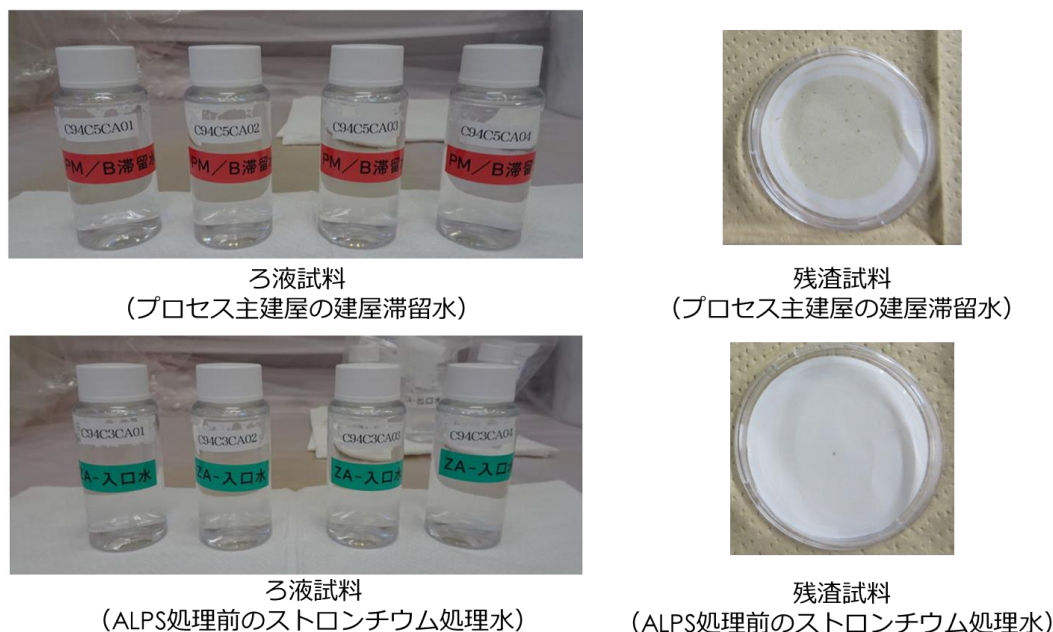
図 1.1.2-4 分析試料 (プロセス主建屋水と ALPS 処理前のストロンチウム処理水) のろ液試料と残渣試料
