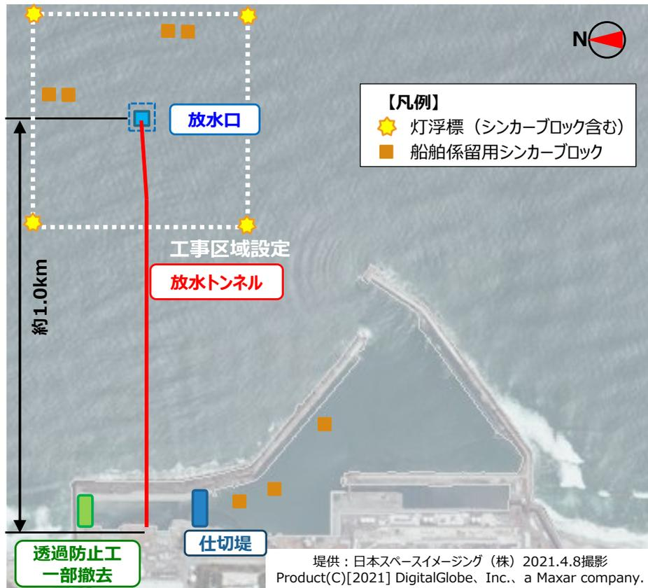
図 2.9.8-9 海上工事概要図（平面）
